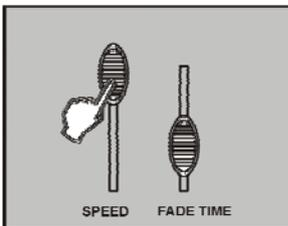
3/ Après avoir sélectionné la banque de scènes que vous souhaitez envoyer, vous pouvez utiliser les potentiomètres SPEED (ou appuyez sur SYNC / DISPLAY) et FADE TIME pour ajuster le défilement des scènes désirées.
