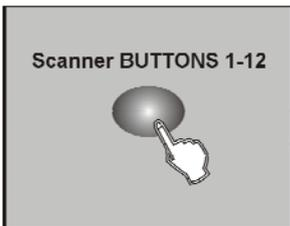
8/ Répétez les étapes de 3 à 7 jusqu'à ce que toutes les scènes désirées soient mémorisées. Appuyez une deuxième fois sur la touche SCANNER pour désactiver le contrôle des potentiomètres. Pour régler un autre scanner, il suffit d'appuyer sur la touche SCANNER correspondante pour activer le contrôle des potentiomètres, puis répétez les différentes étapes de la programmation.
