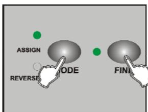
1/ Appuyez simultanément sur les touches FINE et MODE, la LED REVERSE s'allume.
