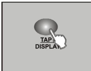
2/ Remettez la console sous tension, et appuyez sur la touche TAP / DISPLAY pour changer entre « Fondu enchaîné » et « Assignment du fondu enchaîné ». L'écran indique :
