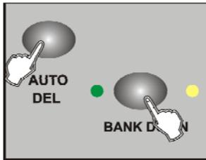
1/ La console hors tension, appuyez et maintenez les touches AUTO / DEL et BANK DOWN simultanément.
