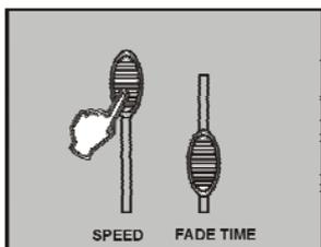
3/ Utilisez les potentiomètres SPEED, (ou appuyez sur SYNC) et FADE TIME pour ajuster le défilement des scènes désirées.
