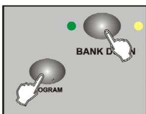
1/ Avec la console hors tension, appuyez et maintenez enfoncée les touches PROGRAM et BANK DOWN simultanément.
