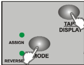
1/ La console hors tension, appuyez simultanément sur les touches MODE et TAP DISPLAY.
