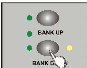
3/ Utilisez les touches BANK UP / DOWN pour changer le PAN ou le 1<sup>er</sup> canal à inverser et le TILT ou le 2<sup>ème</sup> canal à inverser, la LED correspondante indiquera cette sélection.
