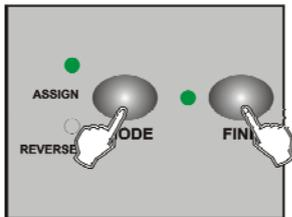
2/ Appuyez sur les touches FINE et MODE simultanément 2 fois, la LED ASSIGN s'allume et indique que le mode ASSIGN est activé.
