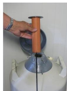
Figure 3 sonde de niveau
