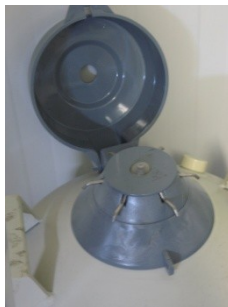
Figure 2 Logement de la sonde de niveau
