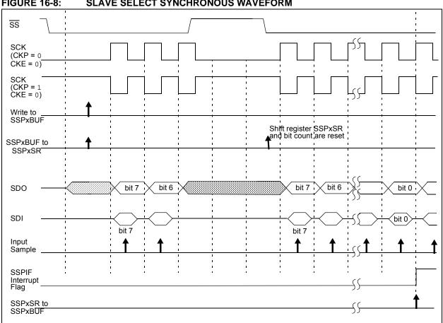
**FIGURE 16-8:** SLAVE SELECT SYNCHRONOUS WAVEFORM
