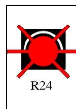
Il est destiné à interdire momentanément la circulation à tout véhicule routier, devant un obstacle ou un danger particulier (passage à niveau, traversée de voies exclusivement réservées aux véhicules des services réguliers de transport en commun, pont mobile, avalanche...).
