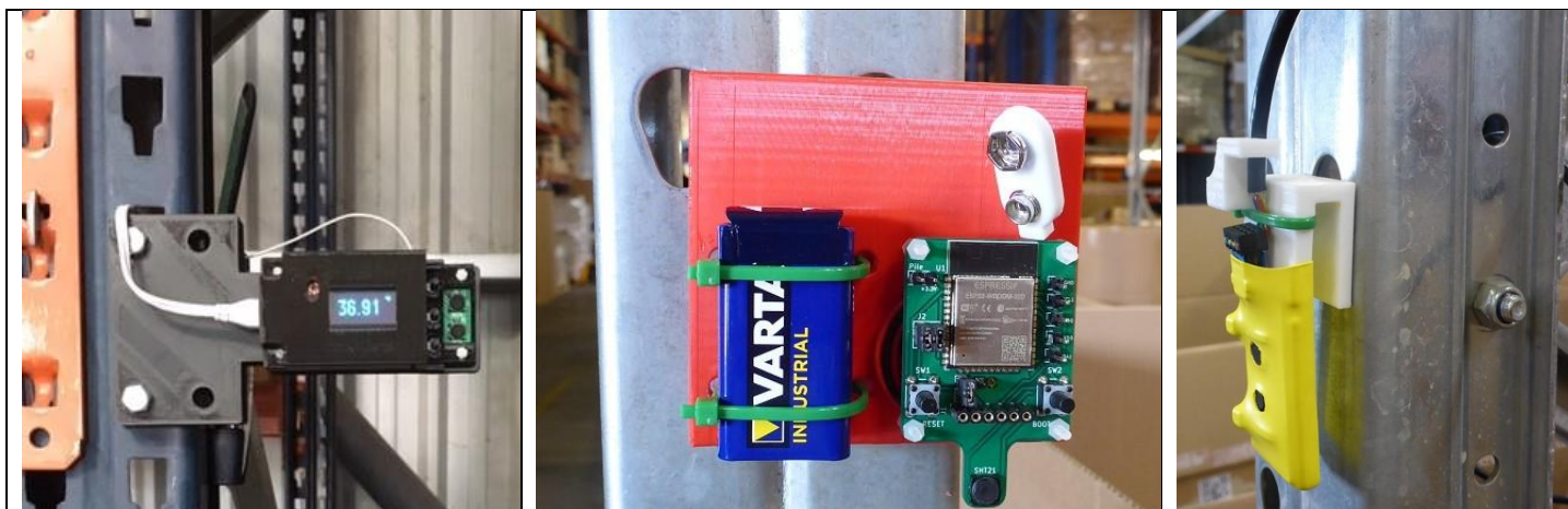
Capteur LoRa sur base d'une carte WiFi LoRa ESP32 (Heltec) et de capteurs SHT21/31
