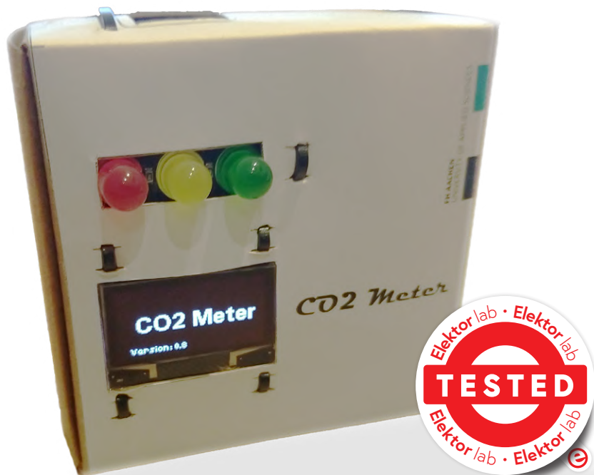
Figure 1. Dispositif final avec feu tricolore et écran dans un boîtier en carton.
