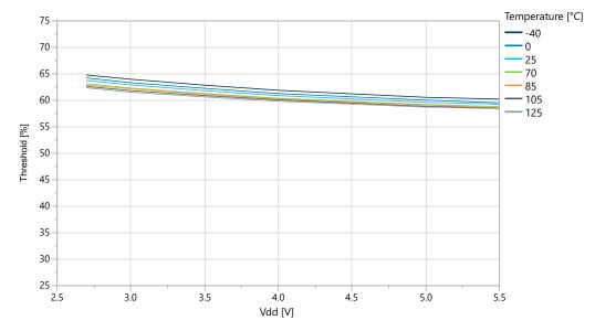
Figure 39-19. I/O Pin Input Threshold Voltage vs.  $V_{\rm DD}$  ( $V_{\rm IL}$ )
