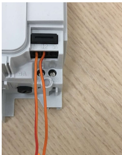
Raccordement du modem au bornier I1 I2 du compteur
