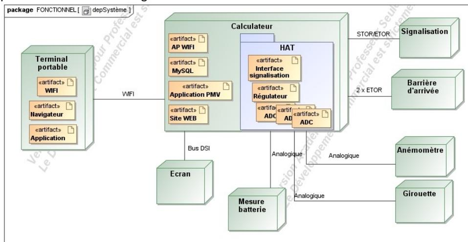
Figure 1 : Diagramme de déploiement du système
